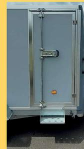
**Système de verrouillage de la porte-pont**
